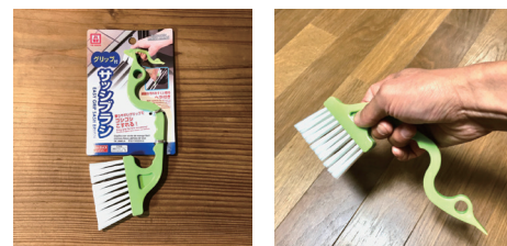
筆者がハウスクリーニングの現場でも使っている、100円ショップダイソーのサッシブラシ。これが意外となかなかのスグレモノ！！使う時はブラシヘッドの根本部分を、親指・人差し指・中指の3本で持ち、残りの2本の指を添えるようにして持つと、ヘッドがいろんな角度に動かせるのでお掃除しやすくなります。
